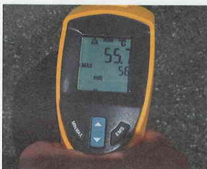
Eine dunkle Bitumenbeschichtung heizt Flachdächer im Laufe des Tages stark auf.
